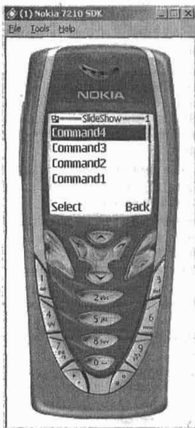
Рис. 3.3. Аппаратно реализованный список команд
